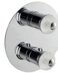
art. 69849E Parte esterna miscelatore termostatico ad incasso con comando per la regolazione della temperatura e comando per l'erogazione e portata dell'acqua. Ingressi ed uscite da 3/4" con riduzioni da 1/2". 1 uscita: da abbinare a incasso art. 27885. 2 uscite: da abbinare a incasso art. 27886. 3 uscite: da abbinare a incasso art. 27887. External part thermostatic concealed mixer with one handle for temperature control and one handle diverter with flow regulator. 3/4" inlets with adapter to 1/2". 1/2" outlets. 1 way: to combine with concealed body art. 27885. 2 ways: to combine with concealed body art. 27886. 3 ways: to combine with concealed body art. 27887.
