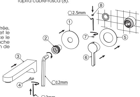
**I INTERVENTI DI MANUTENZIONE****SOSTITUZIONE DELLA CARTUCCIA**
