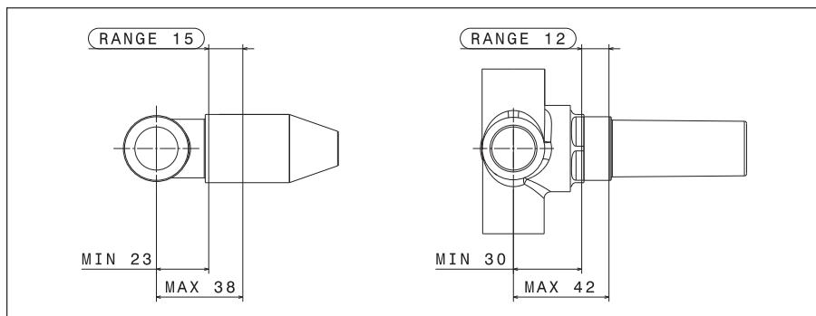
**IT** - Rispettare i limiti d'incasso (minimo e massimo) in riferimento al filo del pavimento e livellare.
