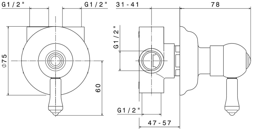
**I** **FASE 1** **Fissaggio e connessione miscelatore**
