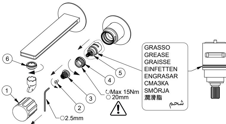
**IT****INTERVENTI DI MANUTENZIONE****SOSTITUZIONE DELLA CARTUCCIA**
