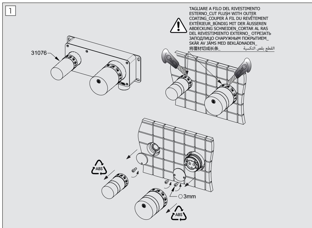
**FASE 1\_PHASE 1\_ÉTAPE 1\_SCHRITT 1\_FASE 1\_1 ЭТАП\_FAS 1 步骤— 1****IT Fissaggio e connessione miscelatore.**
