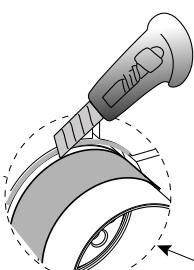
TAGLIARE A FILO DEL RIVESTIMENTO ESTERNO\_CUT FLUSH WITH OUTER COATING\_COUPER À FIL DU REVÊTEMENT EXTÉRIEUR\_BÜNDIG MIT DER ÄUSSEREN ABDECKUNG SCHNEIDEN\_CORTAR AL RAS DEL REVESTIMIENTO EXTERNO ОТРЕЗАТЬ ЗАПОДЛИЦО С НАРУЖНЫМ ПОКРЫТИЕМ\_SKÄR AV JÄMS MED BEKLÄDNADEN\_ 将覆材切成长条 القطع بقص التكسية\_
