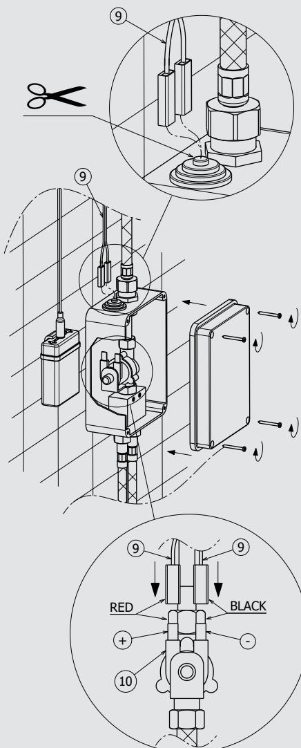
**IT** Tagliare il passacavo quanto basta per l'inserimento e lo scorriamento del cablaggio (9). Inserire quindi quest'ultimo nel passacavo e collegare l'elettrovalvola (10) utilizzando il cablaggio (9), come segue:
