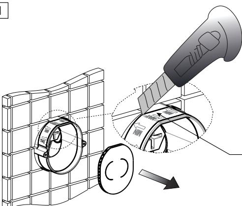
TAGLIARE A FILO DEL RIVESTIMENTO ESTERNO\_CUT FLUSH WITH OUTER COATING\_COUPER À FIL DU REVÊTEMENT EXTÉRIEUR\_BÜNDIG MIT DER ÄUSSEREN ABDECKUNG SCHNEIDEN\_CORTAR AL RAS DEL REVESTIMIENTO EXTERNO\_ОТРЕЗАТЬ ЗАПОДЛИЦО С НАРУЖНЫМ ПОКРЫТИЕМ\_SKÄR AV JÄMS MED BEKLÄDNADEN\_将覆材切成成长条\_القطع بقص التكسية
