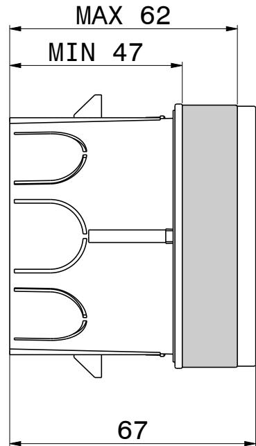
INSTALLAZIONE COMANDO ELETTRONICO REMOTO A PARETE\_ INSTALLATION OF WALL ELECTRONIC REMOTE CONTROL\_ INSTALLATION COMMANDE ELECTRONIQUE A DISTANCE MURALE\_ INSTALLATION DER AN DER WAND BEFESTIGTEN, ELEKTRONISCHEN FERNSTEUERUNG\_ INSTALACIÓN MANDO ELECTRÓNICO DE DISTANCIA DE PARED НАСТЕННЫЙ МОНТАЖ ДИСТАНЦИОННОГО ЭЛЕКТРОННОГО БЛОКА УПРАВЛЕНИЯ\_ VÄGGINSTALLATION AV ELEKTRONISK FJÄRRKONTROLL\_ 安装墙壁电子遥控器\_ ترکیب وحدة التحكم الإلكترونية عن بعد على الجدار\_
