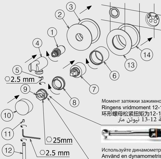
Момент затяжки зажимной гайки 12-13 Нм
