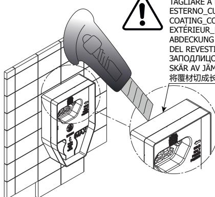
TAGLIARE A FILO DEL RIVESTIMENTO ESTERNO\_CUT FLUSH WITH OUTER COATING\_COUPER À FIL DU REVÊTEMENT EXTÉRIEUR\_BÜNDIG MIT DER ÄUSSEREN ABDECKUNG SCHNEIDEN\_CORTAR AL RAS DEL REVESTIMENTO EXTERNO\_OTРЕЗАТЬ ЗАПОДИЦО СНЯРУЖНЫМ ПОКРЫТИЕМ\_SKÄR AV JÄMS MED BEKLÄDΝADEN\_将覆材切成长条 القطع بقص النكسيه
