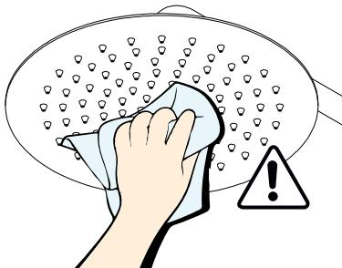
**IT** ATTENZIONE: si consiglia di pulire periodicamente gli ugelli anticalcare con acqua tiepida, strofinandoli delicatamente con una mano o passando una spatola lavavetri da doccia. Gli ugelli otturati dalla presenza di calcare o impurità, potrebbero generare l'aumento della pressione interna al soffione, causando danni irreparabili al prodotto.
