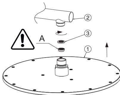
**IT** ATTENZIONE: Controllare che il riduttore di portata (A) sia posizionato correttamente prima di procedere con l'installazione.
